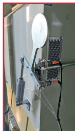
By-pass détection position mécanique ou inductif pneumatique
