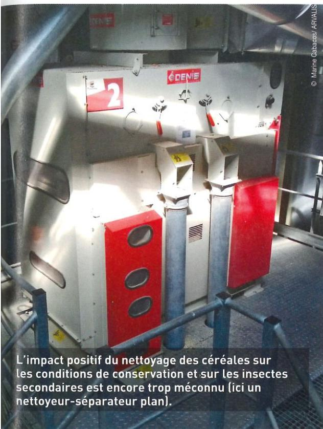
L'impact positif du nettoyage des céréales sur les conditions de conservation et sur les insectes secondaires est encore trop méconnu (ici un nettoyeur-séparateur plan).
