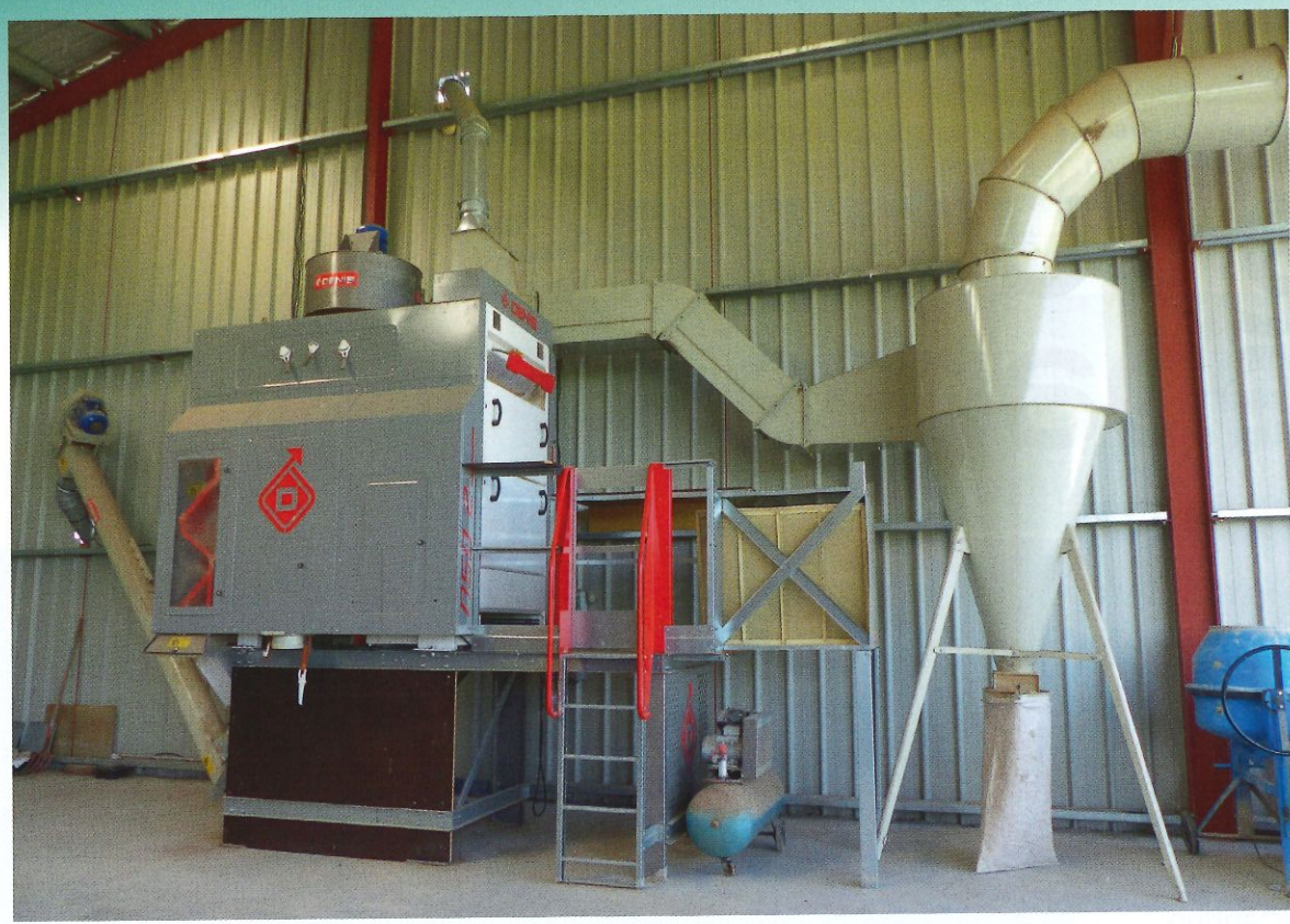
Le séparateur-nettoyeur NSD 2, signé Denis, s'avère particulièrement efficace pour trier les cultures mélangées.
