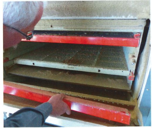
Le nettoyeur nécessite un peu de temps de maintenance pour entretenir ou remplacer les huit grilles lors d'un changement de réglage.
