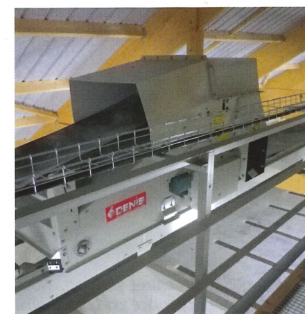
→ Le convoyeur à bande et son chariot déverseur motorisé.
