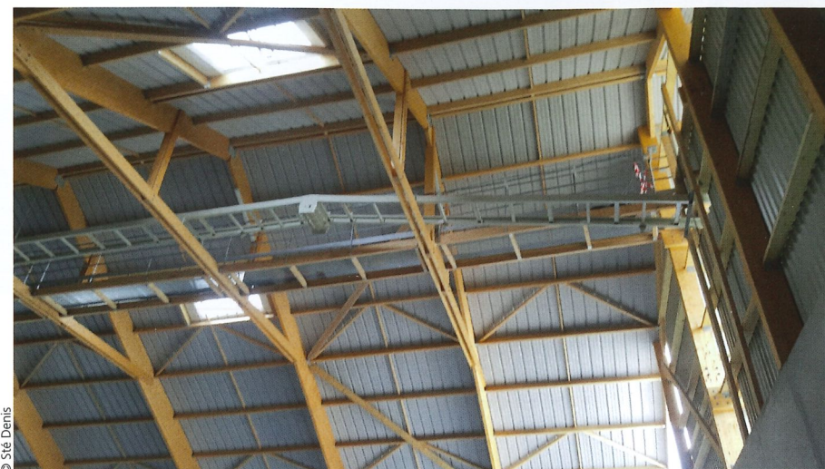
→ L'élévateur à godets à 18 mètres de haut.
