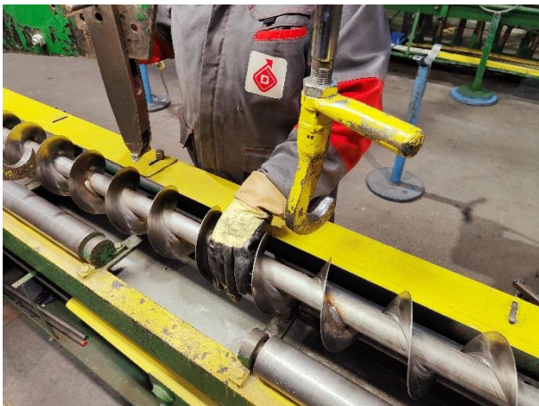
Fabrication des filets et des spires
