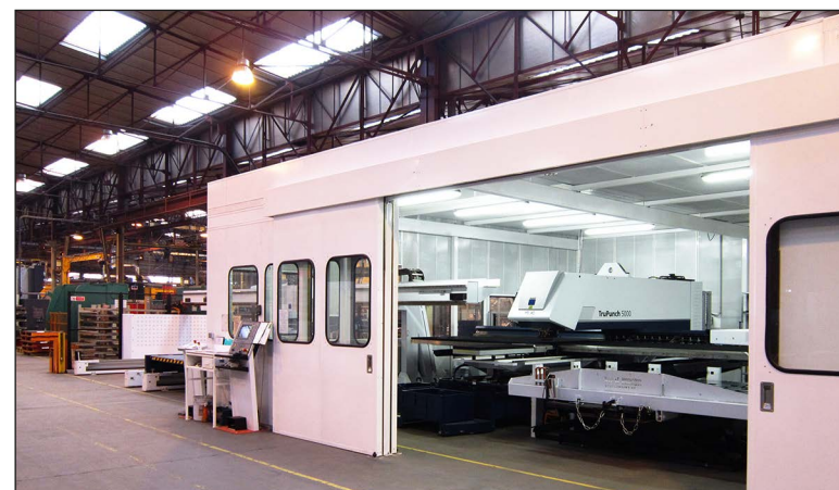
Début 2014, l'entreprise a investi dans une poinçonneuse à commandes numériques automatique.
