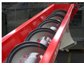
Vis mélangeuse longueur 2,25 m, inclinée à 30°
