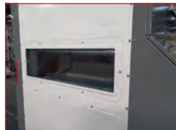
Hublot de visualisation de l'intérieur du séparateur
