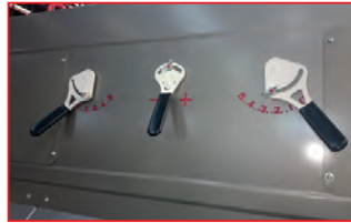
Séparateur équipé de commandes de réglages
