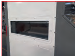
Hublot de visualisation de l'intérieur du séparateur
