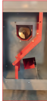
Sortie latérale en bout de grilles sur NSD1
