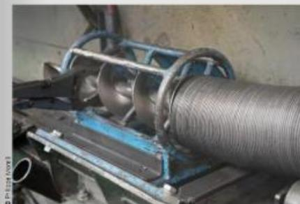
→ Assemblage d'une vis sans fin.
