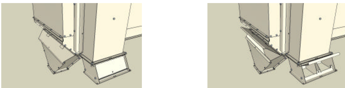
Trémie bon grain et sorties déchets avec prise d'échantillon
